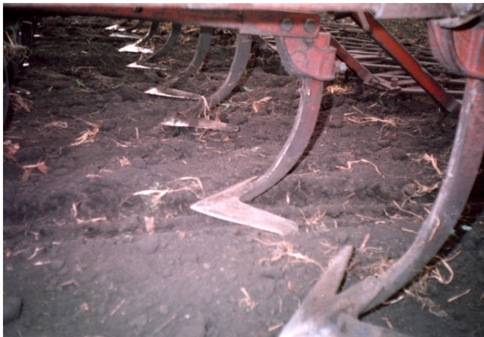
Рисунок 3.19 – Рабочие органы на агрегате из 2 культиваторов КПС-4, установленные по схеме (см. рисунок 3.17)
