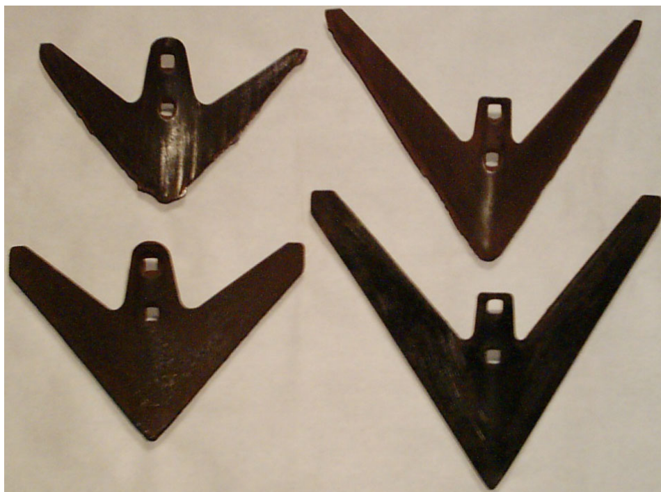
Рисунок 5.12 – Серийные лапы до полевых испытаний (нижний ряд) и после наработки 25,8 га при движении по следам движителей и опорных колес (верхний ряд)
